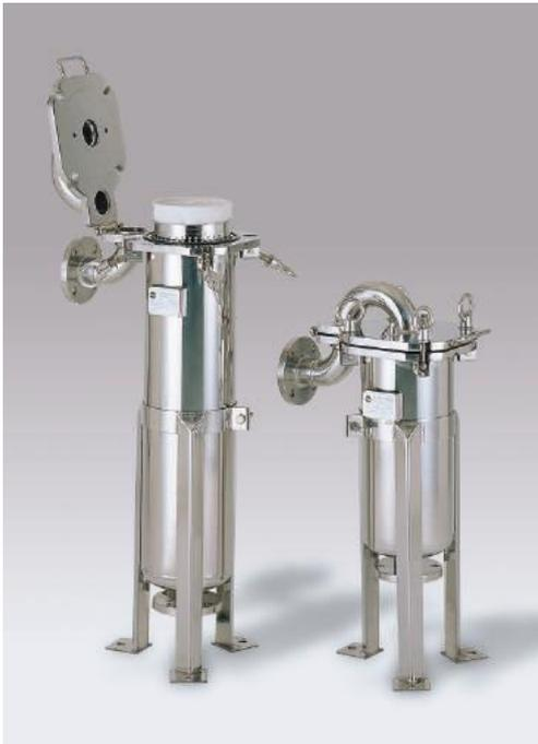
FALAトップエントリーシングルフィルターハウジングは360度シールを確実にする蓋とハウジング本体からできています。この機構は液体をトップから直接バッグフィルターの中に流し込むことができます。すなわちコンタミを確実に捕集し、製品ロスも発生しません。ASMEおよび特注仕様も可能です。
