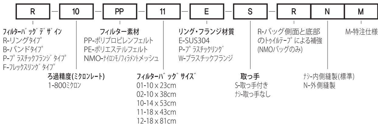
※ FALA標準NMOバッグは200ミクロンまではRマークが略号の中に無くても、バッグ側面と底部がトウilterテープにより補強されています。
